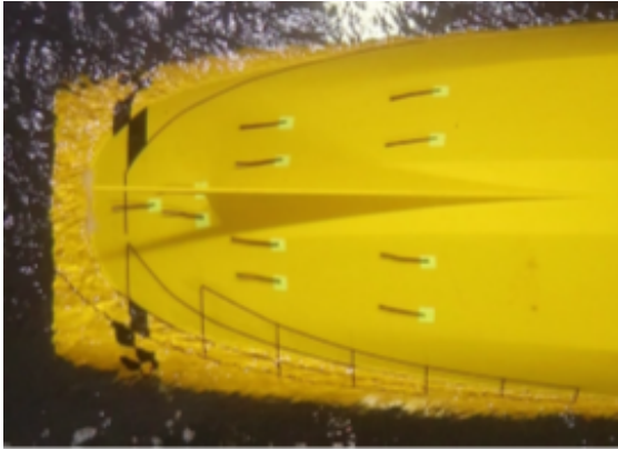
Abbildung 2.28.: Wellenbild bei 12 kn Fahrt, 0° Drift, 0° Krängung (Friedhoff u. Tenzer, 2018)
