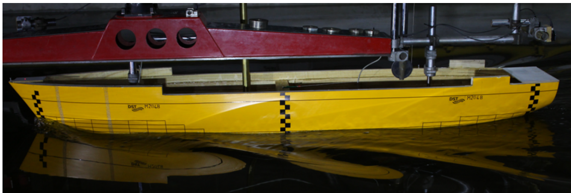
Abbildung 2.25.: Seitenansicht des Wellenprofils am Modell bei 12 kn Fahrt (Friedhoff u. Tenzer, 2018)
